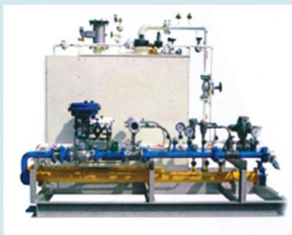
Использование смесительной установки (SNG BLENDER) позволяет за считанные минуты перейти с основного источника природного газа на резервный (пропан-бутан).
